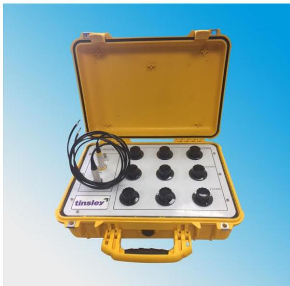
Caixa de Calibração com 9 décadas para checagem de testadores de isolação de altas resistências, com grande precisão, e tensão máxima de saída, 5.000Vcc.
