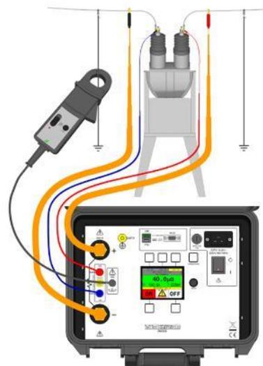
Medições precisas em disjuntores, isoladores e links de aterramento com ambos os lados aterrados são feitos de modo simples com uso da garra de corrente opcional. Isso permite que a corrente que circula pelo aterramento do equipamento seja subtraída da corrente de teste.
