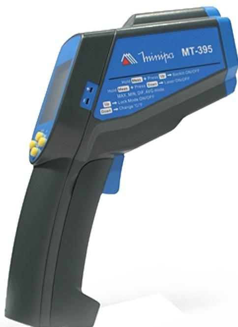
Instrumento digital portátil com relação distância foco de 50 : 1, mira laser (classe II) com determinação de foco, emissividade ajustável 0,10 a 1, LCD de 3 ½ dígitos, com iluminação de fundo e resolução de 0.1°C e 0.1°F, funções avançadas como registro Máximo e Mínimo, Média, Diferencial, Hi e Lo e desligamento automático. Realiza medidas de temperatura na faixa de -60°C a +1500°C através do infravermelho e -64°C a +1400°C com termopar tipo K.
