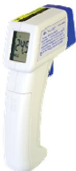
Instrumento digital portátil, com emissividade ajustável de 0.1 ~ 1, mira laser (classe II), LCD de 3 1/2 dígitos, resolução de 0.5°C / 1°C ou 1°F, precisão básica de 2% ou 2°C, congelamento de leitura, desligamento automático, registro de máximo e mínimo, alarme para temperatura alta e baixa e campo de visão de 10:1. Realiza medidas de temperatura na faixa de -30°C a 550°C ou -22°F a 1022°F, com uso do sistema de medida por irradiação infravermelho.
