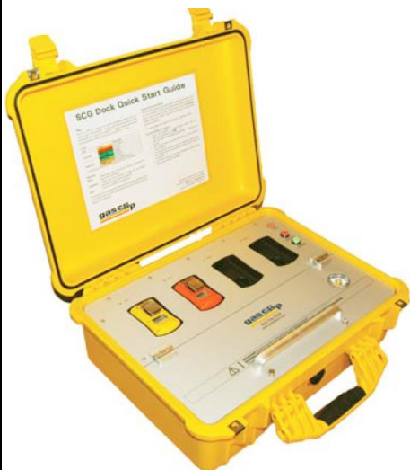
SGC Dock Estação de calibração portátil para até 4 unidades SGC
