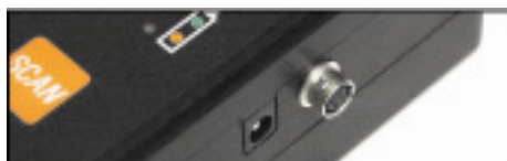
Detalhe do sensor externo e do dispositivo de conexão da antena parabólica
