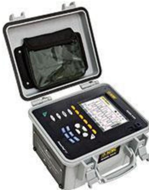
O PowerPad® III Modelo 8435 é um trifásico analisador de qualidade de energia, que é fácil de usar, compacto e resistente ao choque. Ele permite que os técnicos e engenheiros para medir e realizar diagnósticos e um trabalho de qualidade de energia em um, dois ou redes trifásicas. Quatro terminais de entrada de tensão e quatro terminais de entrada de corrente são fornecidos. É à prova d'água IP67 avaliado durante a gravação com a tampa fechada.
