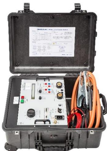
T&R Test Equipment é líder de mercado para equipamentos de injeção de corrente. Suas soluções incluem unidades de injeção secundária de 100A até unidades de correntes de até 6000A de injeção primária. Todas tem medição True RMS, sistema de temporização flexível e interface com usuário de fácil compreensão.
