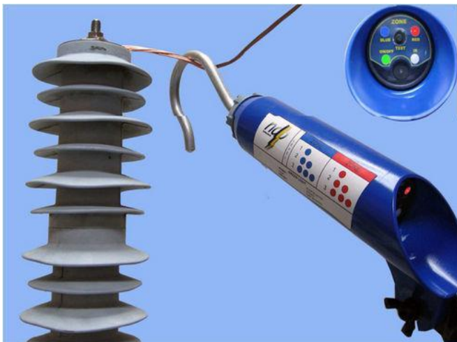
Teste de para raio com ADD
